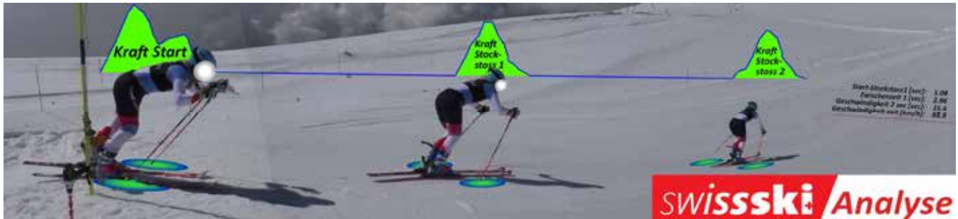
Abbildung 1: Grafische Darstellung der Kräfte auf die Stöcke während der Startbewegung; Exemplarisch erfasste Werte eines Starts
