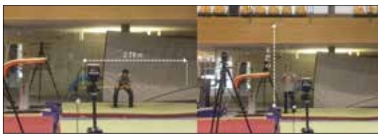
Abbildung 1: Kalibrierung des Messbereiches mittels Definition der Referenzhöhe und –weite mit einem Messstab (2.78 m) in der 2D-Videoanalyse-Software (Dartfish).
